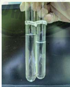
Gambar 14.13 Penyetaraan Mc Farland dengan Suspensi Bakteri Escherecia Coli
