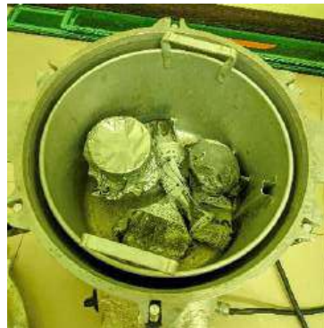
Gambar 14.11 Penyeterilan Alat-Alat dengan Autoklaf
