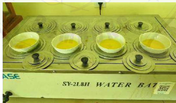
Gambar 14.7 Proses Pemekatan Ekstrak dengan Water Bath
