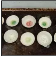
Proses perendaman sampel menggunakan 5 ml \text{HNO}_3 pekat sebelum 24 jam
