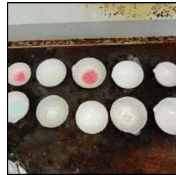
Proses perendaman sampel menggunakan 5 ml \text{HNO}_3 pekat setelah 24 jam
